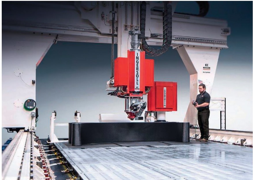
5 3D-Druck und Herstellung von CFK-Verbundwerkstoffen: Auf den MasterPrint und Mon-goose-Maschinen von Ingersoll laufen in rekordverdächtigen Dimensionen AFP (Automated Fiber Placement)-Prozesse ab © Innse-Berardi
